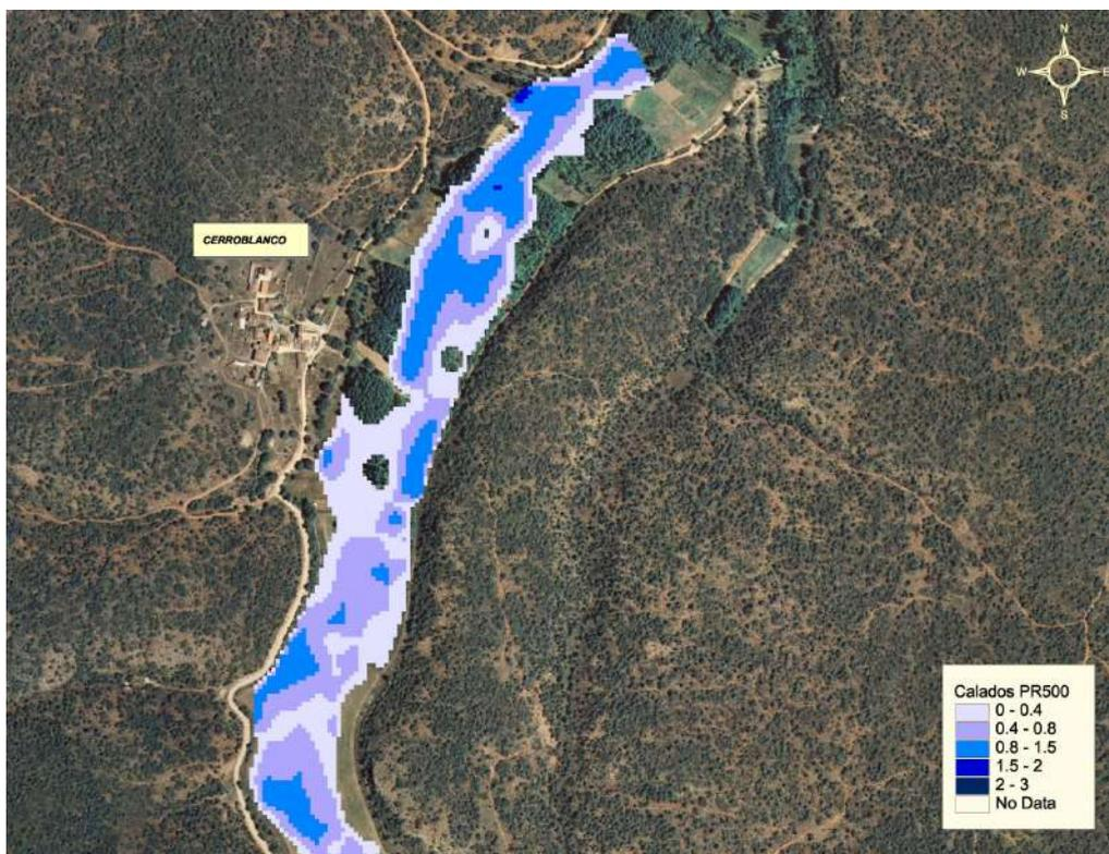
Planta de calados de inundación para P.R. 500 en el núcleo de Cerroblanco
