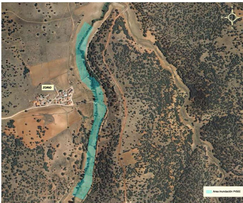
*Planta área de inundación para P.R. 500 en el núcleo de Zorio.*
