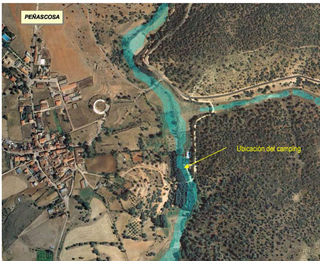
*Planta área de inundación para P.R. 100 en el río Arquillo a la altura del camping de Peñascosa*
